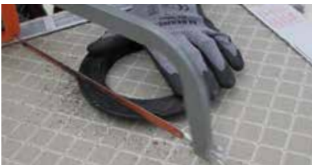
3. Girar la base y retirar uno de los lados a lo largo de la línea precortada.
