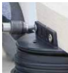
20.* Atornillar la viga en el soporte a través de las correspondientes ranuras (utilizar un destornillador).
