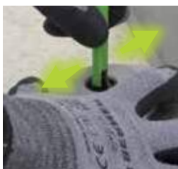
10. Retire las otras dos pestañas con la llave SUPAK.
