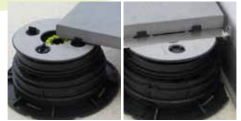
14. Appuyez les angles de la dalle entre les ailettes.
