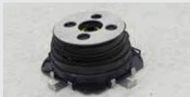
F-2. Coloque el soporte con los ángulos cortados hacia el exterior.
