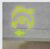
D4. Coupez le carreau de la même hauteur entre le profil BSJ et le clip SUPACLPB.
