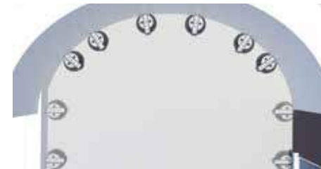
8. Colocar los soportes en las posiciones indicadas en el esquema de diseño.
