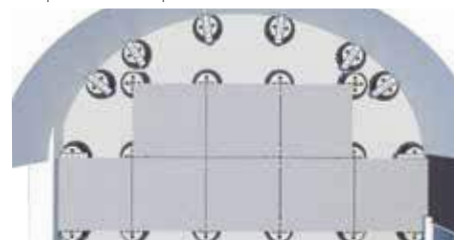
14. Placer les carrelages entiers en suivant le schéma de pose.
