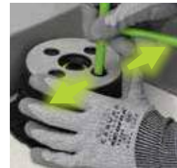
3. Retire las cuatro aletas con la llave SUPAK.
