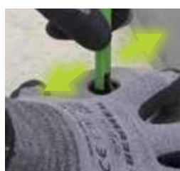
10. Coupez les deux autres ailettes avec la clé SUPAK.
