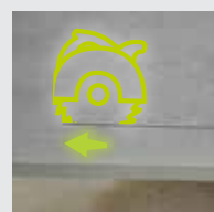
F4. Coupez le carreau de la mesure correspondant l'hauteur entre le profil BSJ et le clip SUPACLPB.
