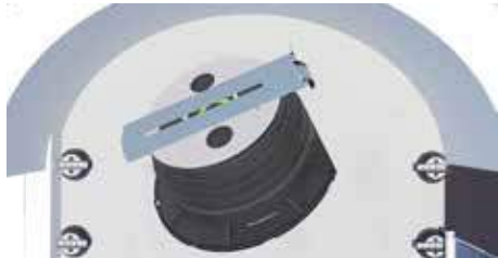
7. Placer la cale SUPACLPP perpendiculairement au mur.
