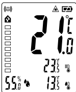
Kondensatsioonniiskuse oht puudub
